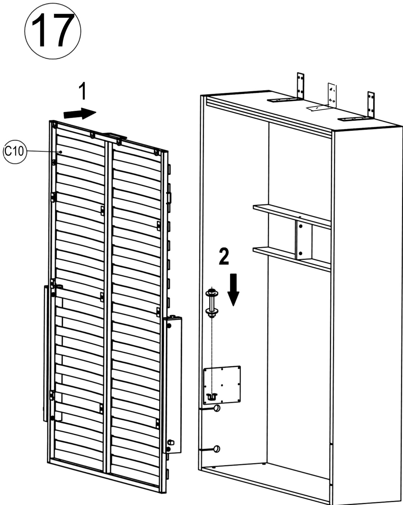
Enclencher le carré du vérin dans le "U" (T1). Trou du carré vertical pour le passage du boulon, visser le boulon pour fixer le carré.
